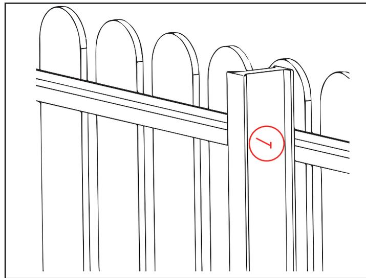
Ubicar los cercos preensamblados en cada una de la vigas, asegurandolos con tornillos de ensamble de 4", que se incertan de manera diagonal para garantizar el ajuste de los cercos que comparten viga.
