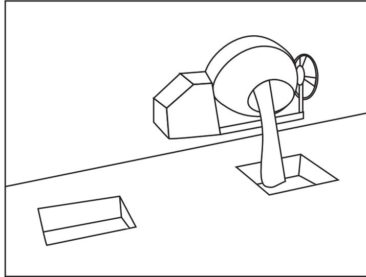
Vacear una capa de 15 centímetros de cemento a los orificios. Dejar secar 12 horas.
