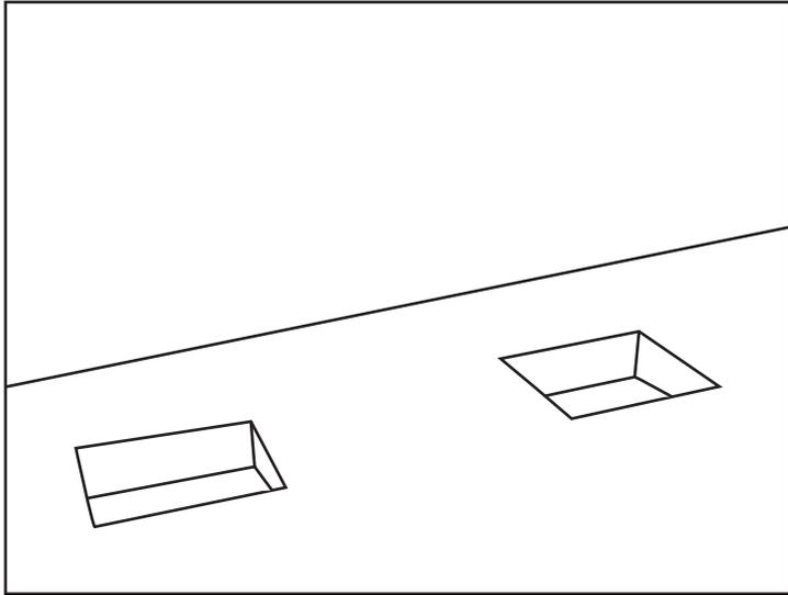
Aplanar el terreno en donde se va a realizar la instalación del cerco y abrir orificios de 15 x 20 cm con 40 cm de profundidad.
