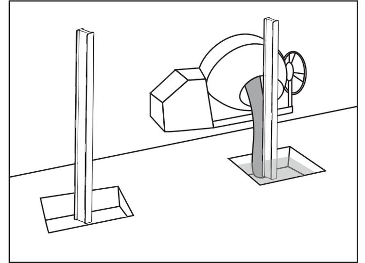
Ubicar las vigas en el dentro de los orificios y terminar de llenar con la mezcla preparada hasta completar los 40 cm. Dejar secar 24 horas.
